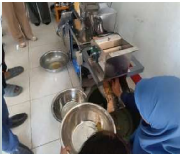
Gambar 2. Penggunaan alat mesin perajang dan penghancur rimpang pada UMKM Lab Herbal NTT untuk peningkatan kualitas produksi dan pemasaran
