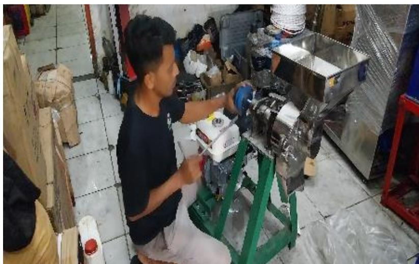
Gambar 4. Persiapan Mesin Penggiling Bumbu
