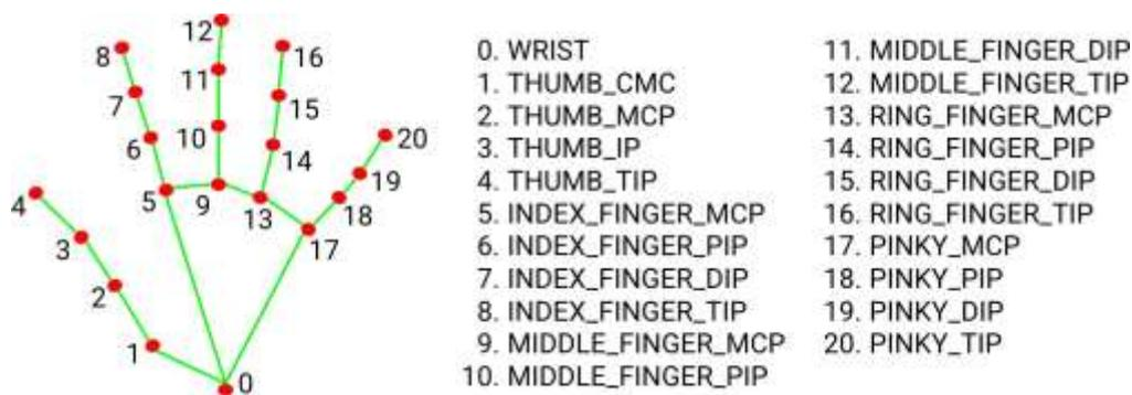
Gambar 3. 21 titik kerangka tangan MediaPipe
