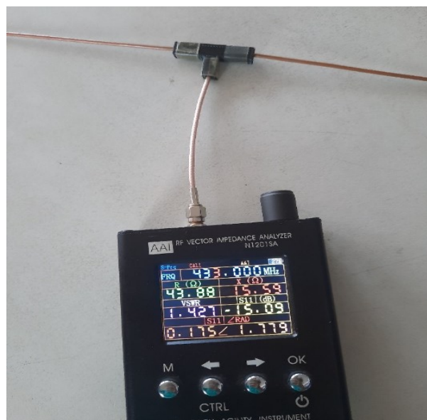
Gambar 7. hasil pengukuran menggunakan Rf vector impedance analyzer
