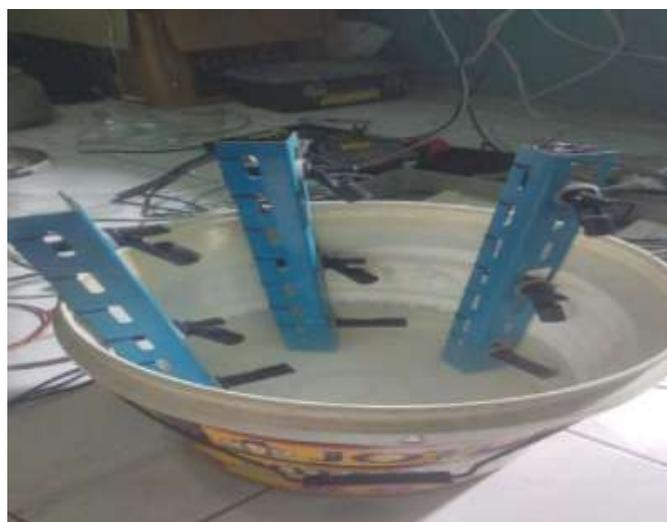
Gambar 9. Pengujian sensor ketinggian air
