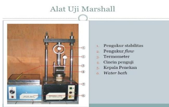
Gambar : Alat Uji Marshall
