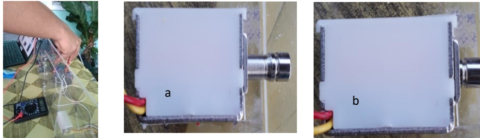
Gambar 8. Pengujian Pengukuran Tegangan (a) Solenoid tidak mendapat tegangan (b) Solenoid mendapat tegangan
