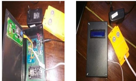
Gambar 11. Alat monitoring permukaan air laut
