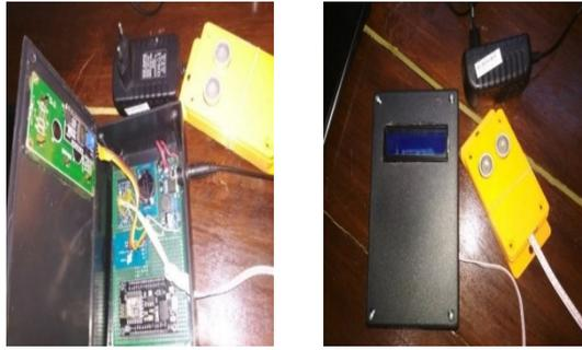
Gambar 11. Alat monitoring permukaan air laut
