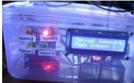
Gambar 10. Informasi Kebocoran tangki
