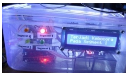
Gambar 4.3 Informasi Kebocoran tangka
