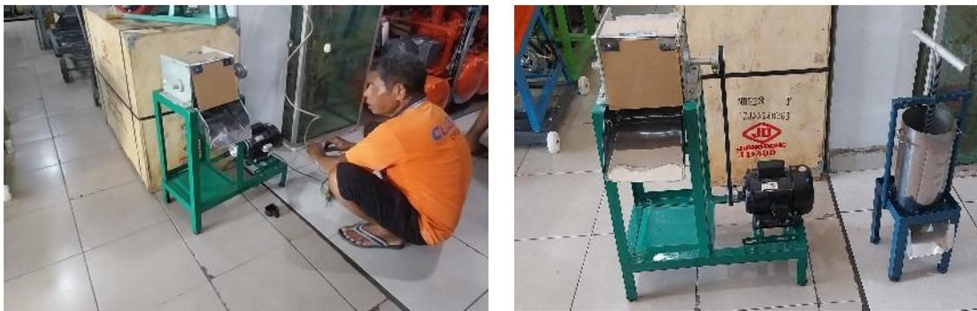
Gambar 2. Pengujian Mesin Parut Listrik dan tersedianya Mesin Parut Listrik alat peras kempa manual Sumber : (Muntasir et al., 2025)
