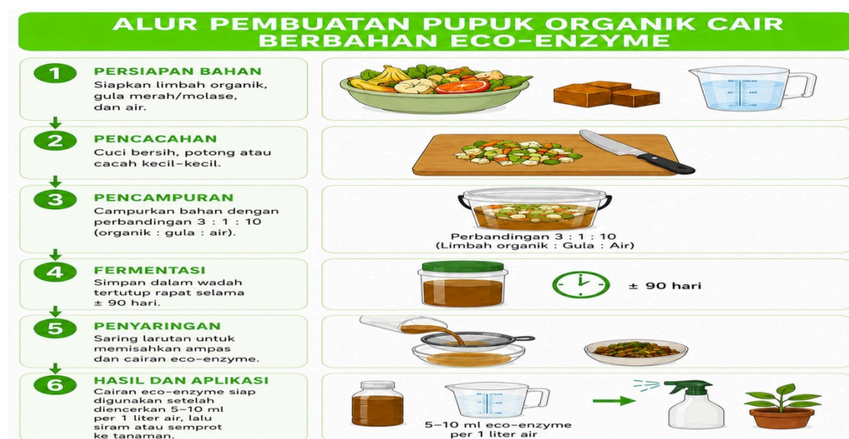
Gambar 3. Diagram alir proses pembuatan eko-enzim untuk Pupuk Organik Cair (POC)
