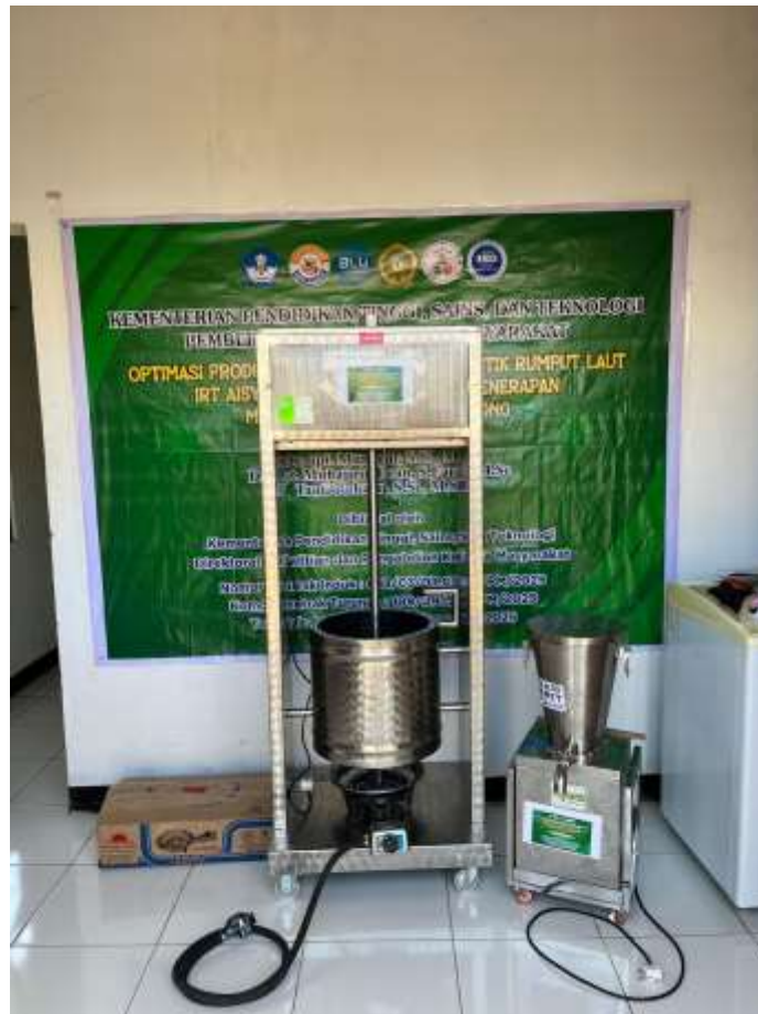
Gambar 8. Alat yang diintervensi untuk Pemberdayaan masyarakat Optimasi Produksi Dodol, Kerupuk, dan Stik Rumput Laut IRT Aisyiah Alak Kupang Melalui Penerapan Mesin Pengaduk dan Pemotong
