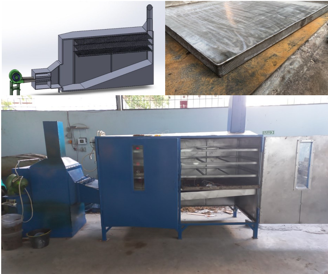
Gambar 7. Pembuatan Pengering Hasil Perkebunan Berbasis Energi PLTMH (Sumber: Dokumentasi Pribadi, 2024)
